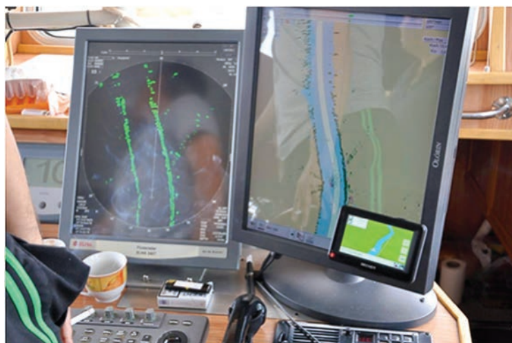
Slika 92. Prikaz displeja ECDIS na komandnom mostu broda i pozicije sopstvenog plovila na elektronskoj navigacionoj karti
